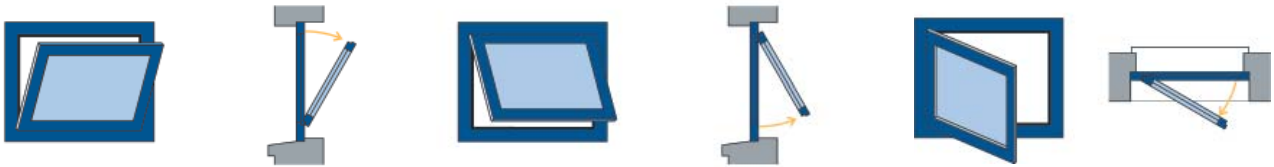
(Apertura hacia dentro) sobre el eje inferior
